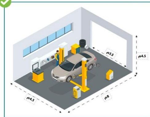
شكل توضيحي (4): رسم توضيحي لقسم ميزان السيارات
